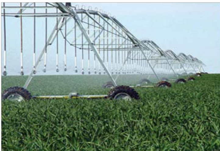
Fig. 10. Echipamente de aspersiune cu mai multe suporturi cu deplasare frontală.
